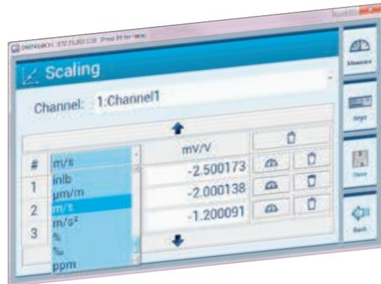
Conversion de la grandeur électrique (mV/V) en grandeurs physiques (par ex. kg, N, Nm, Pa), par une linéarisation sur 2 à 11 points effectuée individuellement pour chaque voie
