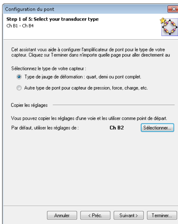
Figure 8.8 : Configuration du pont Étape 1 sur 5
