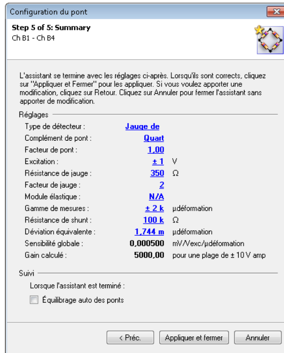
Figure 8.9 : Configuration du pont Étape 5 sur 5
