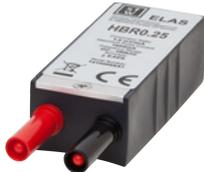
Niederohmiger Hochpräzisions-Bürdenwiderstand 0,25 $\Omega$ , 1 W, 0,02 %. Der interne 4-Leiter-Anschluss verringert die Ungenauigkeit, die von den durch den Bürdenwiderstand verlaufenden Strömen verursacht wird. Verwendung von Sicherheits-Bananensteckern für Eingangsstecker und Ausgangskontakte. Direkt kompatibel mit den Datenerfassungskarten GN610B/GN611B.  | Bestellung über den Support (Custom Systems) <sup>(1)</sup> |
