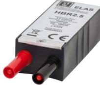
Niederohmiger Hochpräzisions-Bürdenwiderstand 2,5 $\Omega$ , 1 W, 0,02 %. Der interne 4-Leiter-Anschluss verringert die Ungenauigkeit, die von den durch den Bürdenwiderstand verlaufenden Strömen verursacht wird. Verwendung von Sicherheits-Bananensteckern für Eingangsstecker und Ausgangskontakte. Direkt kompatibel mit den Datenerfassungskarten GN610B/GN611B. | Bestellung über den Support (Custom Systems) <sup>(1)</sup> |
