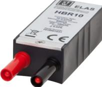
Niederohmiger Hochpräzisions-Bürdenwiderstand 10 $\Omega$ , 1 W, 0,02 %. Der interne 4-Leiter-Anschluss verringert die Ungenauigkeit, die von den durch den Bürdenwiderstand verlaufenden Strömen verursacht wird. Verwendung von Sicherheits-Bananensteckern für Eingangsstecker und Ausgangskontakte. Direkt kompatibel mit den Datenerfassungskarten GN610B/GN611B.  | Bestellung über den Support (Custom Systems) <sup>(1)</sup> |
