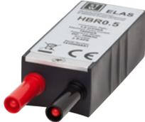
Niederohmiger Hochpräzisions-Bürdenwiderstand 0,5 $\Omega$ , 1 W, 0,02 %. Der interne 4-Leiter-Anschluss verringert die Ungenauigkeit, die von den durch den Bürdenwiderstand verlaufenden Strömen verursacht wird. Verwendung von Sicherheits-Bananensteckern für Eingangsstecker und Ausgangskontakte. Direkt kompatibel mit den Datenerfassungskarten GN610B/GN611B.   | Bestellung über den Support (Custom Systems) <sup>(1)</sup> |
