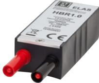
Niederohmiger Hochpräzisions-Bürdenwiderstand 1 $\Omega$ , 1 W, 0,02 %. Der interne 4-Leiter-Anschluss verringert die Ungenauigkeit, die von den durch den Bürdenwiderstand verlaufenden Strömen verursacht wird. Verwendung von Sicherheits-Bananensteckern für Eingangsstecker und Ausgangskontakte. Direkt kompatibel mit den Datenerfassungskarten GN610B/GN611B.    | Bestellung über den Support (Custom Systems) <sup>(1)</sup> |
