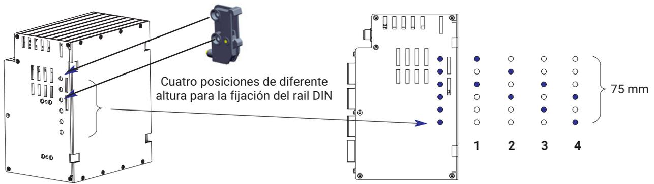
Dispositivo básico, **WGX001/WGX002** para un máx. de 5 módulos enchufables
