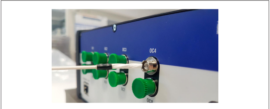
Fig. 3.28 Nettoyage de l'adaptateur d'un connecteur de l'interrogateur
