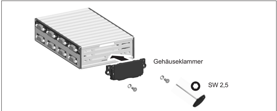
Abb. 6.4 Gehäuseklammer CASECLIP montieren
